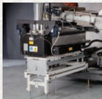
可移进移出的锡槽
